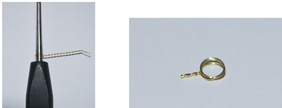
Colocamos el anillo de alambre a la altura del tudel y seguidamente cerramos la pala con el alambre tirando de él. La caña se cierra de una forma uniforme por ambos lados, quedando completamente sellada. Con este tipo de fijación
